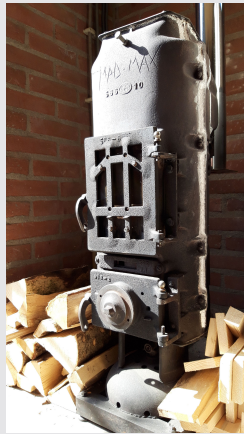
8. MadMax, oud binnenwerk van een hout potkachel. Voet is bovenkant van een gasfles. Schoorsteen gemaakt van een dikke stalen tafelpoot.
